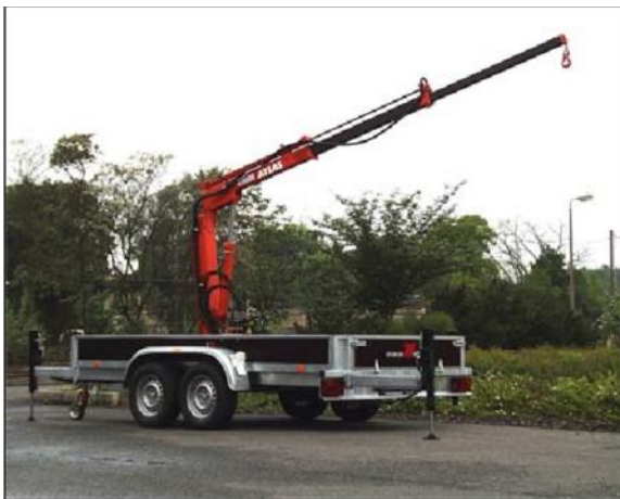
Kranhaken fest 1. Ausschub hydraulisch, 2. Ausschub mechanisch
