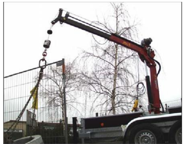
Kranhaken mittels elektrischer Seilwinde bewegbar
