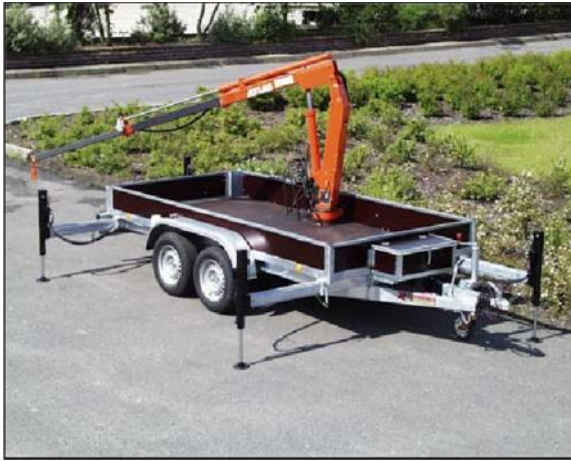
Anhänger und Kran in verschiedenen Größen und Laststufen; Ladekran 210° schwenkbar
