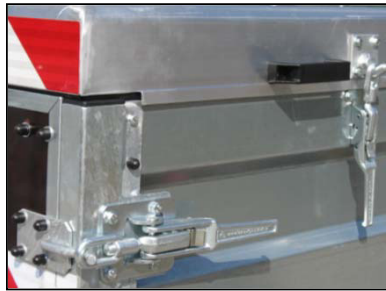
Exzenterverschlüsse mit Sicherheitstaste einstellbar, für Deckel und Rampe
