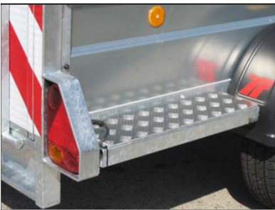
Auftritt aus Aluminium-Riffelblech, rechts hinten
