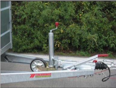
Automatikstützrad, montiert mittels Adapter direkt an Auflaufeinrichtung
