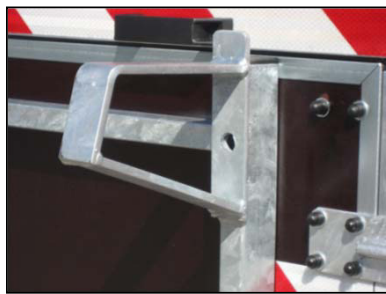
Zwangsabstützung für Auffahrrampe
